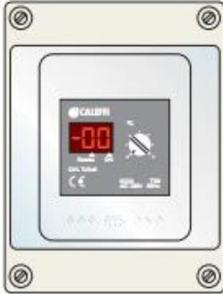
El controlador adquiere las señales de temperatura de las sondas instaladas en la salida del panel y en la caldera. El controlador calcula la diferencia entre las dos temperaturas y por comparación con el valor establecido, controla la bomba de circulación del circuito primario solar.
